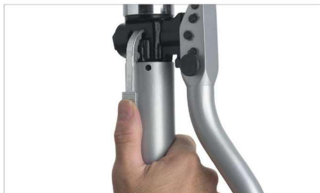
Fig. 12-7 Acționarea cursorului de rapel la RAUTOOL press HPU 32
